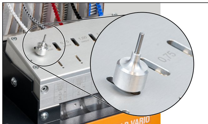
Ilustracja 5.9 Luzowanie paska z tulejkami kablowymi
