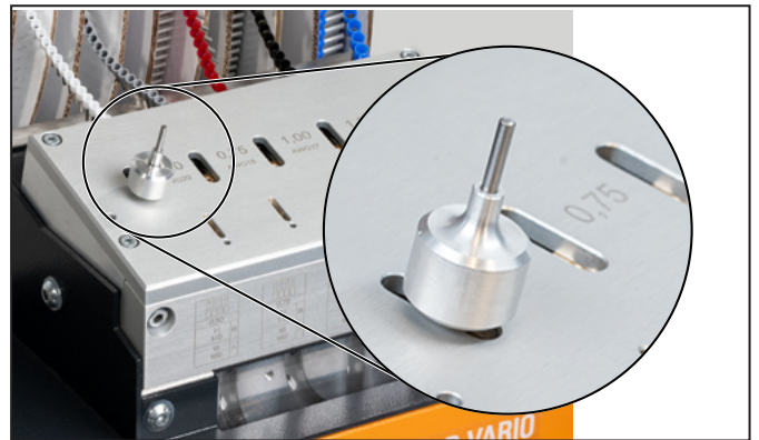
Figura 5.9 Solte a cinta de ponteiras
