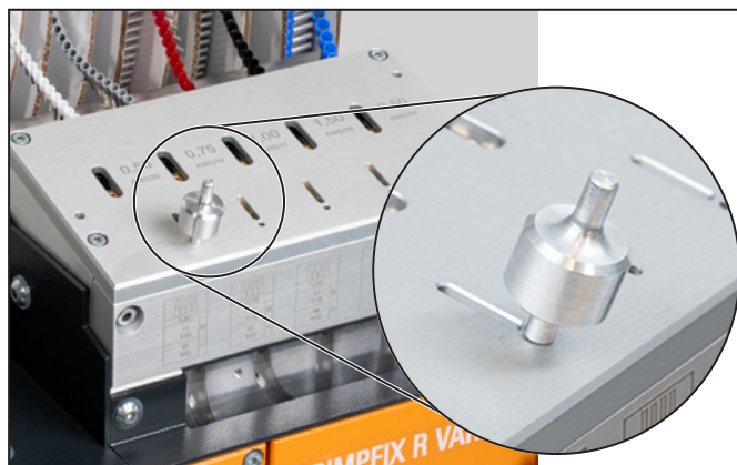
图5.3 固定管状端头带
