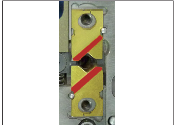
Figura 9.2 Inserimento delle lame
