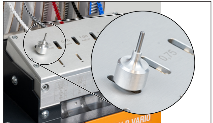
5.9 ábra Érvéghüvely szalag kioldása
