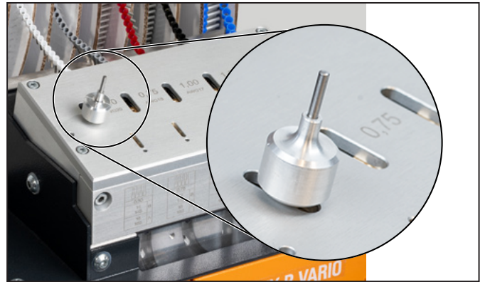
Ilustración 5.9 Extracción de la cinta de terminales tubulares
