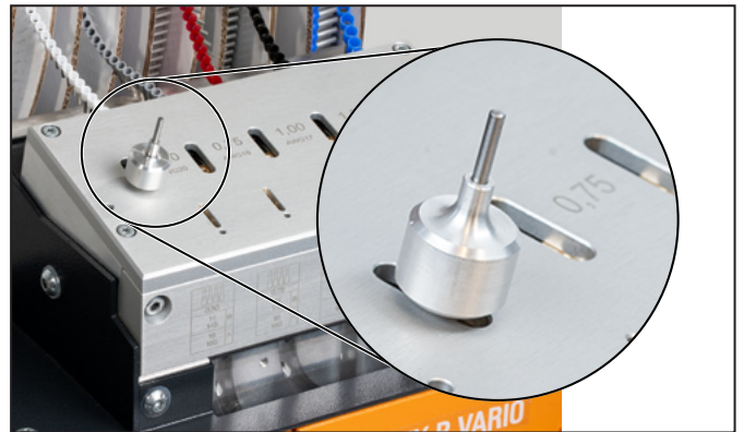
Obrázok 5.10 Uvoľnenie pásu s koncovými dutinkami
