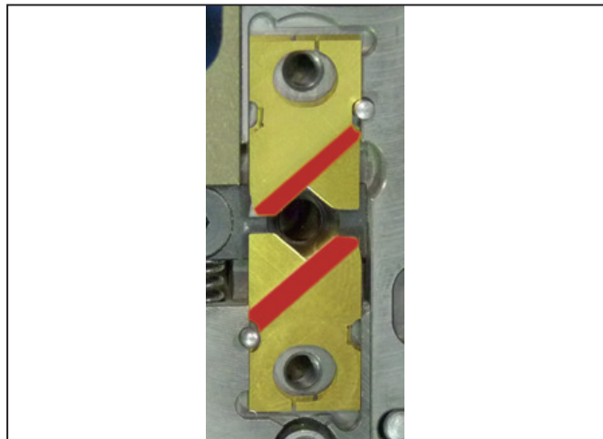
Ilustrace 9.2 Vložení čepelí
