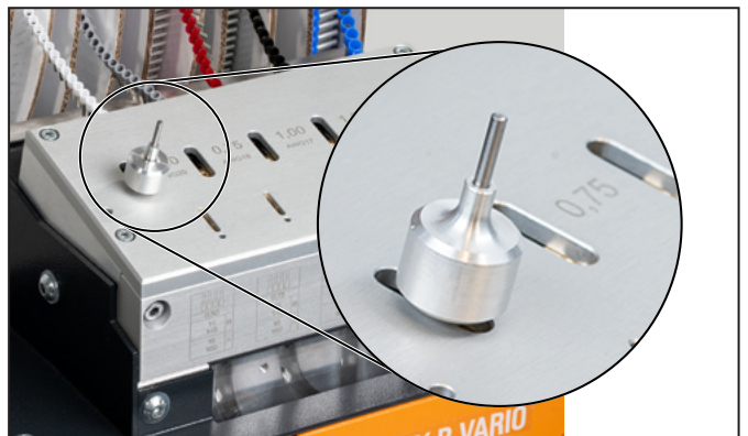
Figura 5.9 Staccare il nastro di terminali
