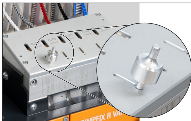
Obrázok 5.3 Upevnenie pásu káblovej koncovky
