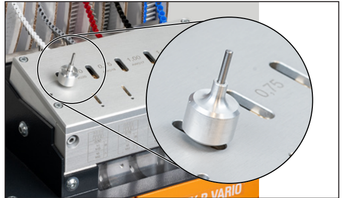
Imagine 5.9 Desfacerea benzii cu manșoane de protecție a extremităților de cablu
