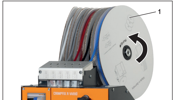
Figure 5.2 Insertion des rouleaux d'embouts
