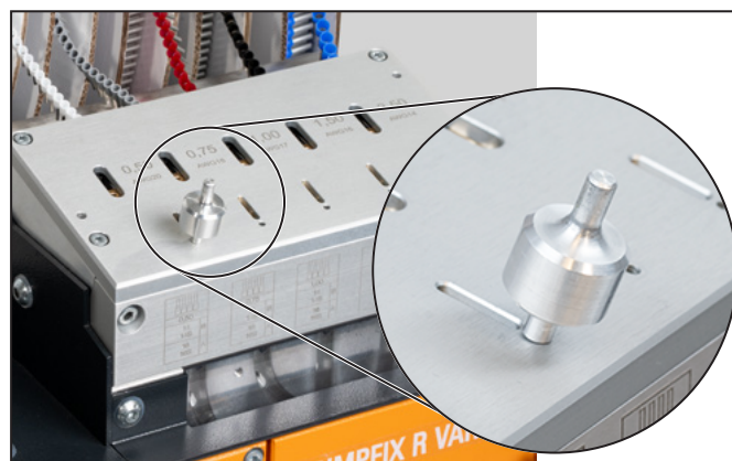
Figura 5.3 Fixar a correia da ponteira
