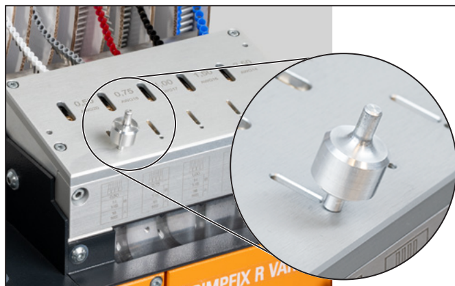
Ilustracja 5.3 Mocowanie pasa tulejek kablowych
