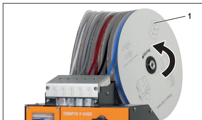
Figura 5.2 Inserir rolos de ponteiras
