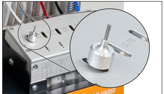
Figure 5.9 Extraire la sangle d'embouts
