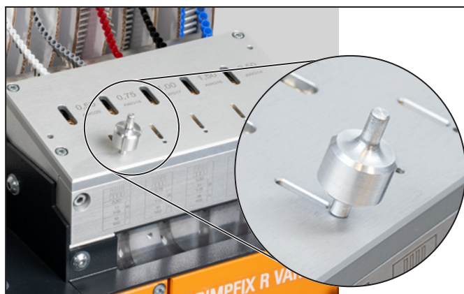
Ilustrace 5.3 Upevnění pásu s koncovkami
