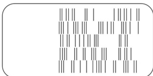
Figure 6.5 Image d'impression : env. 50 % des buses sont opérationnelles
