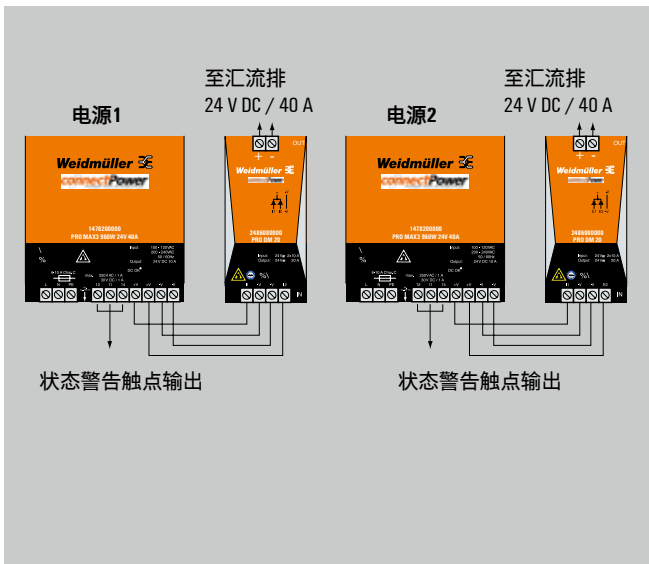
图(4)两台40 A电源并联
