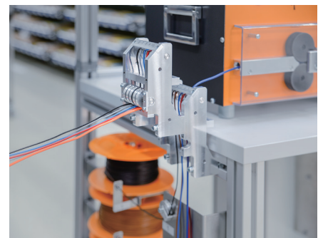
ケーブルの種類ごとに給送口を用意
