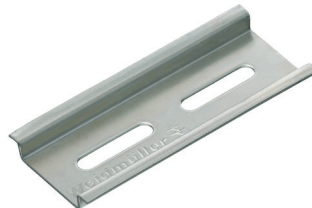
TS 15/5.5 mm导轨, EN 50045 (s = 1.0 mm)
