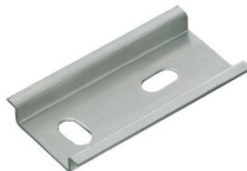
TS 35/7.5 mm导轨, EN 50022 (s = 1.0 mm)
