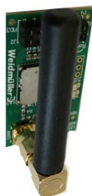
Figura 44. Placa de circuito impreso con módulo LoRa® RF integrado
