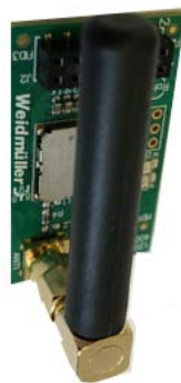
Figura 47. Placa de circuito impreso con módulo LoRa® integrado
