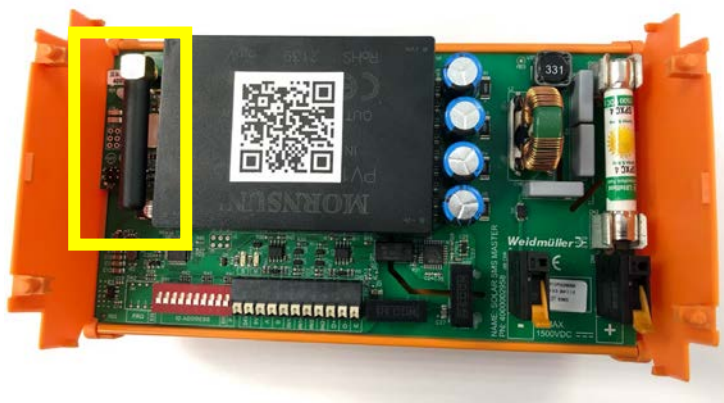
Figura 45. Localización del módulo LoRa® RF en el Solar SMS Master LoRaWAN®
