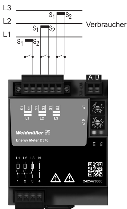
Abb.: Anschlussbeispiel, Strommessung über Stromwandler
