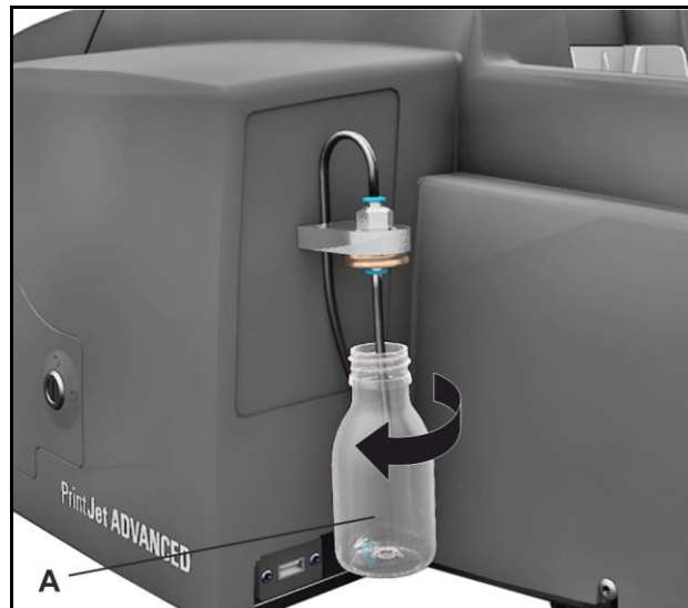
Abbildung 178 Flasche abschrauben
