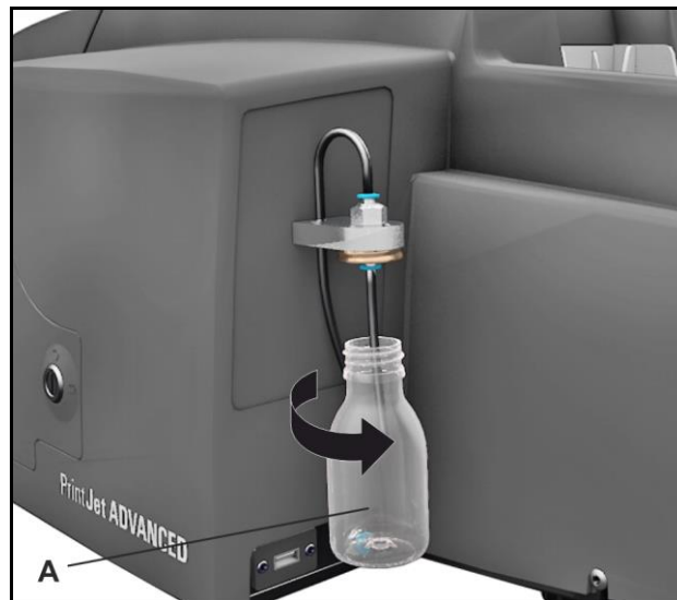
Abbildung 179 Flasche festschrauben
