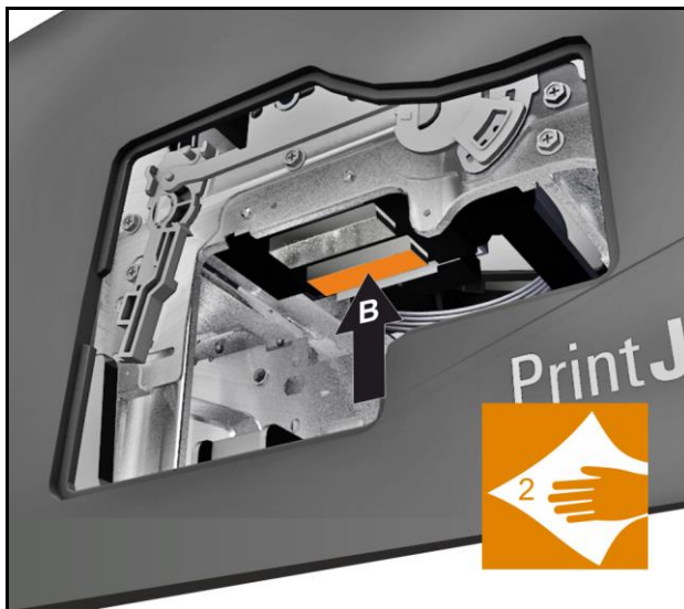
Figure 166 Nettoyer la tête d'impression B
