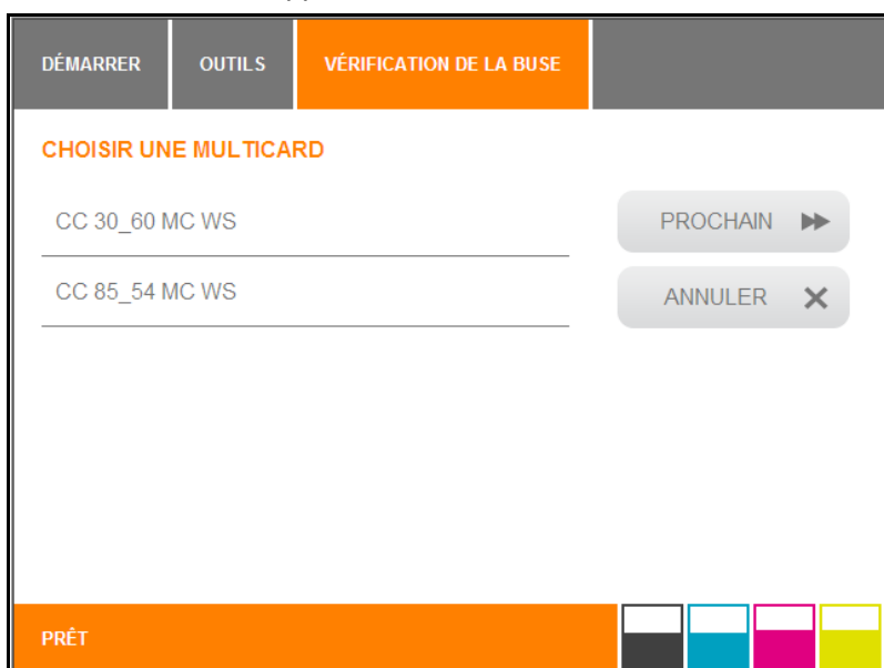
Figure 139 Écran tactile – Choisir une MultiCard pour vérifier la buse
