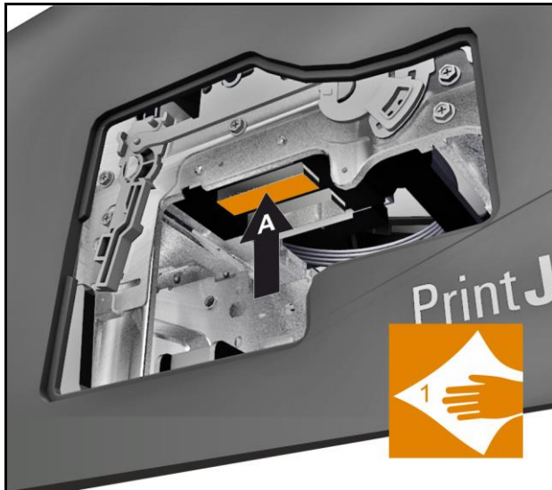
Figure 165 Nettoyer la tête d'impression A
