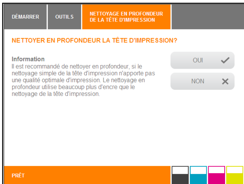
Figure 135 Écran tactile – Nettoyage en profondeur de la tête d'impression
