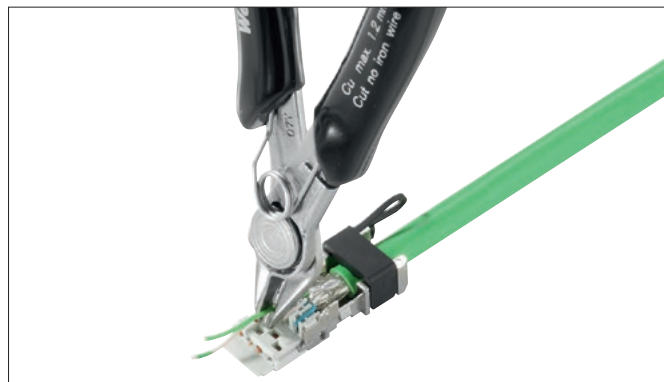
2. Adern konfektionieren und kürzen
