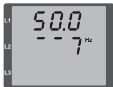
Abb.: Anzeige der Netzfrequenz (50.0) und der Drehfeldrichtung
