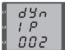
Abb.: Parameter-Einstellung zur dynamischen Vergabe (DHCP) einer TCP/IP-Adresse
