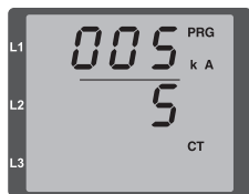
Abb.: Programmier-Modus Stromwandler: Über die Tasten 1 und 2 können Primär- und Sekundärstrom geändert werden (vgl. Seite 22).
