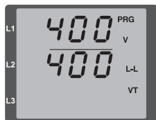
Abb.: Programmier-Modus Spannungswandler: Über die Tasten 1 und 2 können Primär- und Sekundärstrom geändert werden (vgl. Seite 22).
