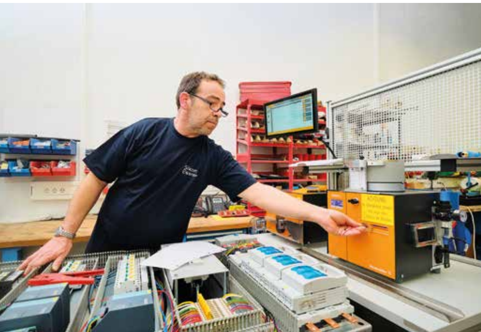
Die Kabel müssen nur in das Wire Processing Center, kurz WPC, gesteckt werden: Hier werden sie automatisch passend abgelängt, während gleichzeitig schon die Leitermarkierer gedruckt werden.
