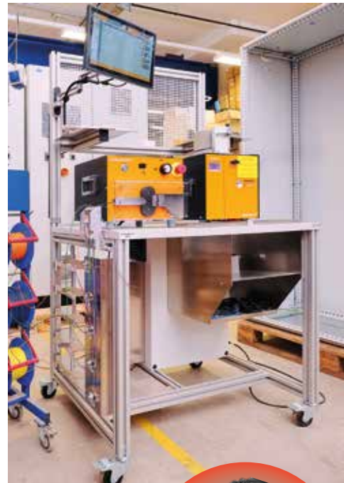
Das WPC besteht aus einem Ablängautomaten, einem Abisolier- und Crimpautomaten sowie einem Thermotransferdrucker. Kabelzuführungssysteme für Kabelrollen oder eine Zuführung von vorgelagerten Systemen bspw. für größere Kartonboxen ergänzen das Center.
