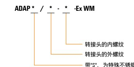
举例 : ADAPS M20 -NPT 1/2- WM 不锈钢转接头 M20外转NPT1/2内
