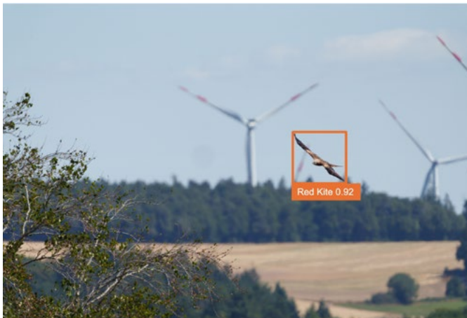
Darstellung der Vogeldetektion durch AVES Wind mit Arterkennungs-KI unter Angabe der Wahrscheinlichkeit
