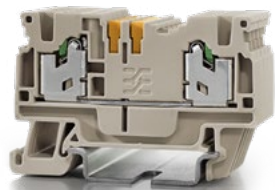
Federanschluss mit PUSH IN-Technologie
