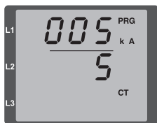
Abb.: Programmier-Modus Stromwandler:
