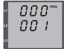
Abb.: Programmier-Modus Parameteranzeige: Über die Tasten 1 und 2 können die einzelnen Parameter geändert werden (vgl. Seite 19).
