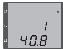
Abb.: Messwertanzeige Betriebsstundenzähler
