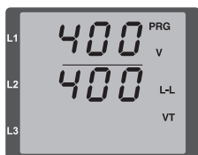
Abb.: Programmier-Modus Spannungswandler:
