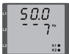
Abb.: Anzeige der Netzfrequenz (50.0) und der Drehfeldrichtung
