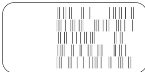
Εικόνα 6.5 Εικόνα εκτύπωσης: περ. 50 % ακροφύσια με δυνατότητα λειτουργίας
