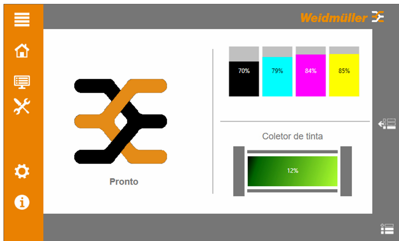
Figura 3.6 Imagem inicial (menu principal “Estado do sistema”)
