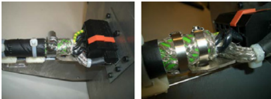
Verschiedene Anbindungen des Kabelschirms an den Steckverbinder
