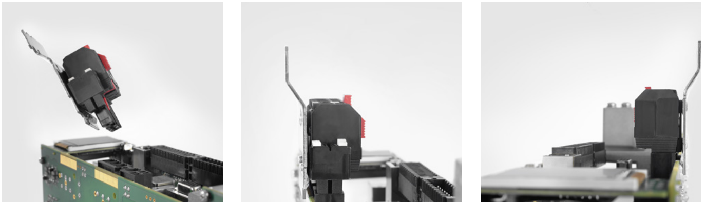
Kontaktierung der Leiterplatte mit der Schirmauflage
