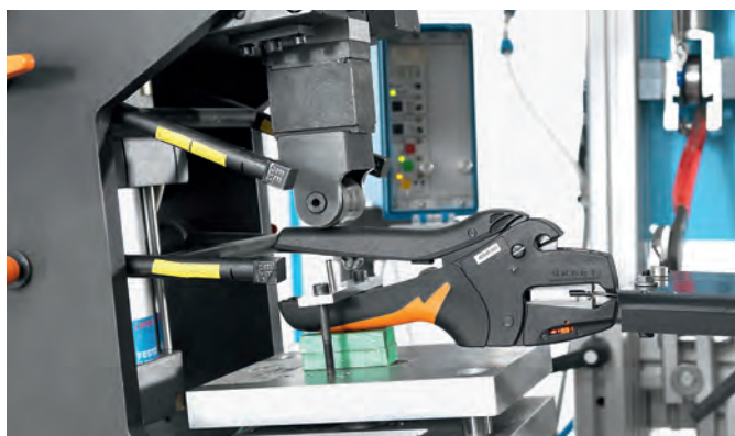
A stripax® tartósságának tesztelése a Weidmüller laboratóriumában
