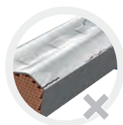
Törések keletkeznek a benyomódások mellett.
