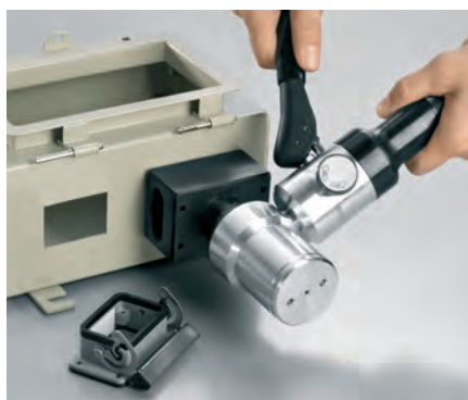
Az előfűrt lyuk automatikusan középen tartja bélyeget, ipari nehézcsatlakozók számára történő lyukasztáskor.
