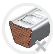
Törések keletkeznek oldalt, kinyílik a hüvely.
