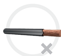
Isolierung nicht einwandfrei eingeschnitten
