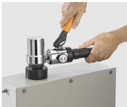
Mit dem hydraulischen Blechlocher werden passgenaue Löcher für die Anbringung von metrischen und PG Verschraubungen gestanzt.
