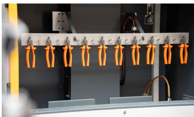
10.000 V Prüfung für 1.000 V Sicherheit bei den Schneidwerkzeugen
