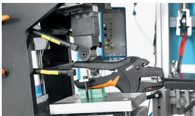
Lebensdauerprüfung der stripax® im Weidmüller Labor
