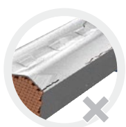
Rissbildung an den Abdrücken des Crimpstempels
