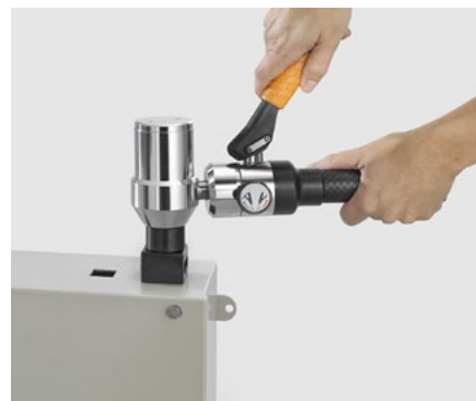
Ausstansen von unterschiedlichen Industrial Ethernet Verbindungen.
