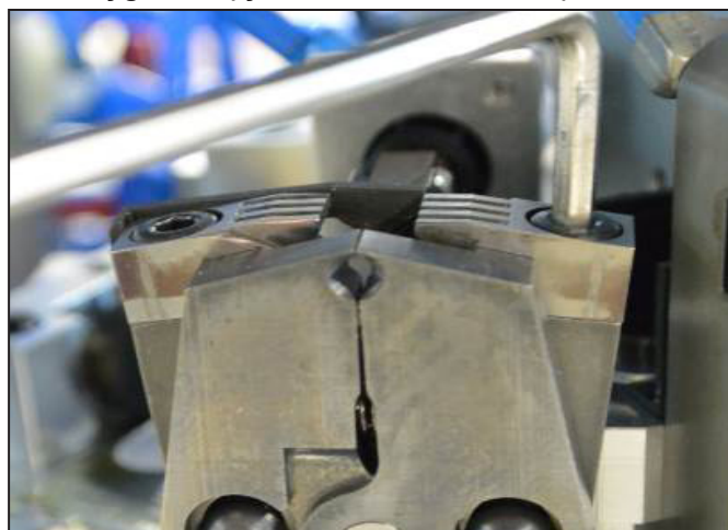
Ilustracja 7.7 Demontaż szczęk zaciskowych PZ3
