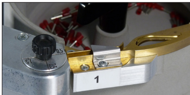
Ilustracja 5.1 Pokrętło regulacji przekroju tulejki (ustawienie: 0,5)
