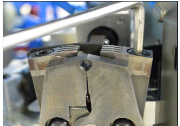
Figure 7.21 Retrait des matrices de sertissage PZ3
