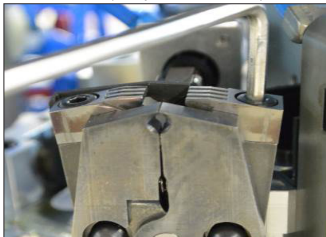
Figura 7.7 Rimozione delle matrici di crimpatura PZ3
