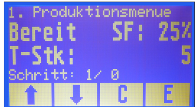
Bild 6.2 Touchdisplay, Anzeige nach dem Einschalten
