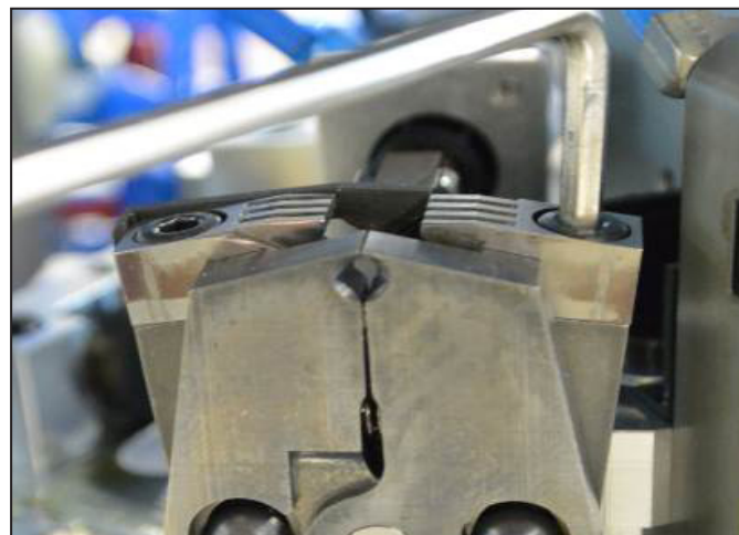
图7.7 移除 PZ3 压接模具
