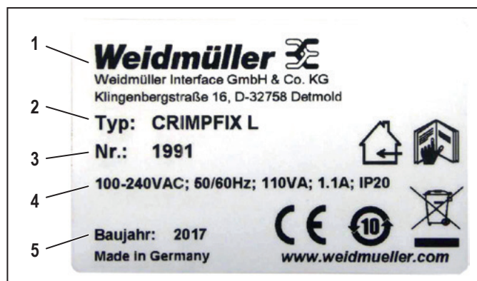
ábra 3.3 Típus tábla a gép hátsó oldalán
