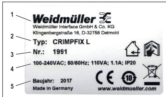
Kuva 3.3 Tyypikilpi sijaitsee laitteen takaosassa
