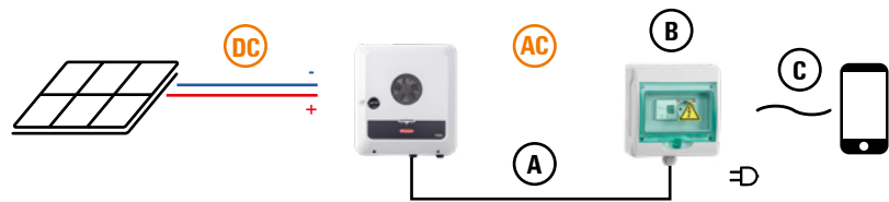
(A) 1-phasige Leitung (B) Notstrom-Box (C) 1-phasige Leitung mit Schuko-Stecker
