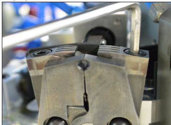
Bild 7.7 Ta bort PZ3 crimpformer
