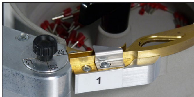
Ilustracja 5.1 Pokrętło regulacji przekroju tulejki (ustawienie: 0,5)
