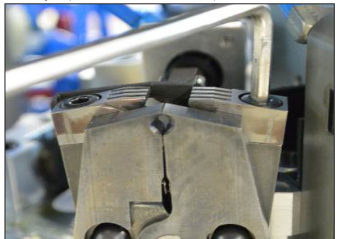
Afbeelding 7.7 Verwijderen van de PZ3 krimpmatrijzen
