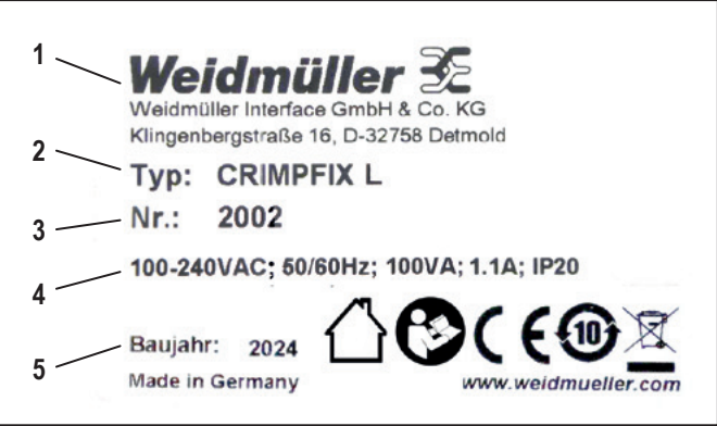
Figura 3.3 Placa de identificação na parte de trás da máquina
