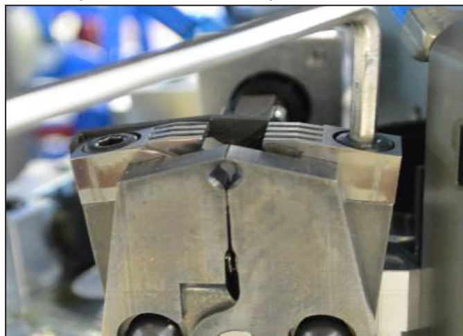
ábra 7.7 A PZ3 krimpelő szerszám eltávolítása
