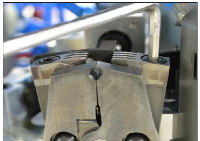
Figura 7.7 Rimozione delle matrici di crimpatura PZ3
