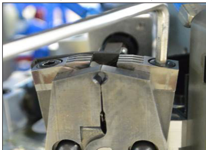
Рисунок 7.7 Снятие форм обжима PZ3
