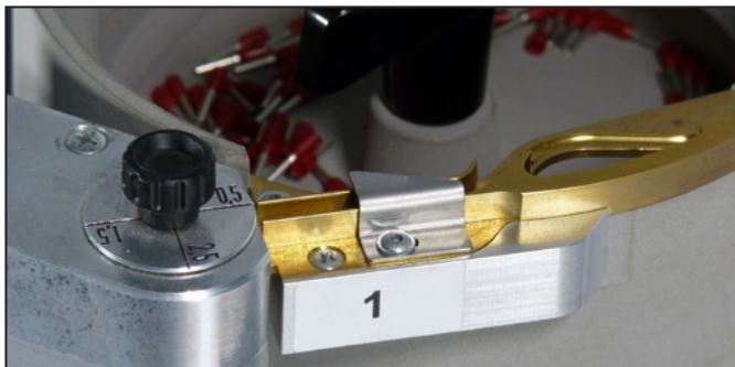
Kuva 5.1 Holkin poikkipinnan säätöpyörä (asetus: 0,5)
