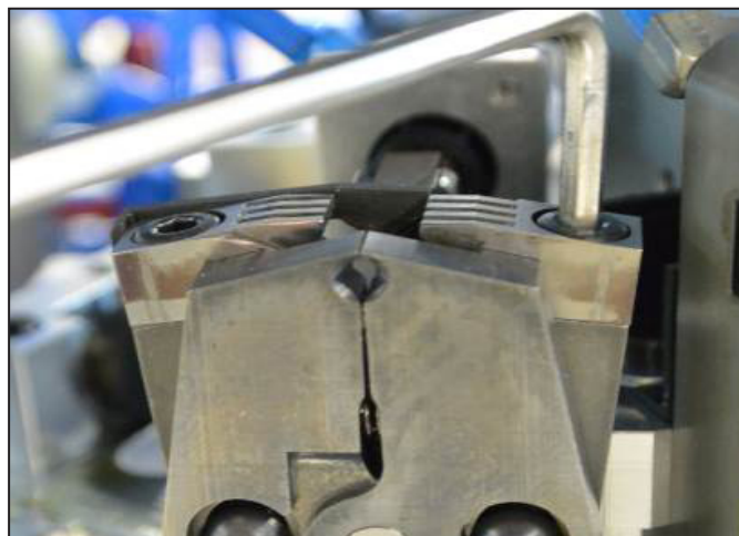
图7.7 移除 PZ3 压接模具
