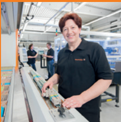
Assemblierung einbaufertiger Klemmenleisten
