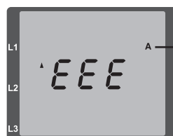
Abb.: Anzeige Messbereichsüberschreitung im Strompfad der 2. Phase (I2)
