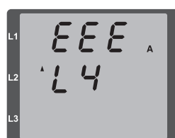
Abb.: Anzeige Messbereichsüberschreitung im Strompfad I4
