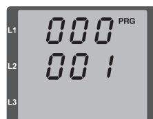
Abb.: Programmier-Modus Parameteranzeige:
