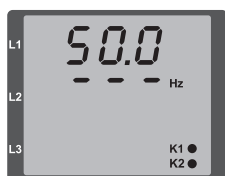
Abb.: Keine Drehfeldrichtung feststellbar.
