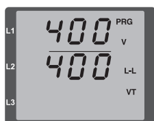
Abb.: Programmier-Modus Spannungswandler:
