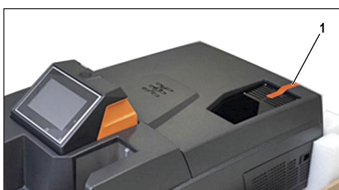
Figura 4.1 Fissaggio per il trasporto
