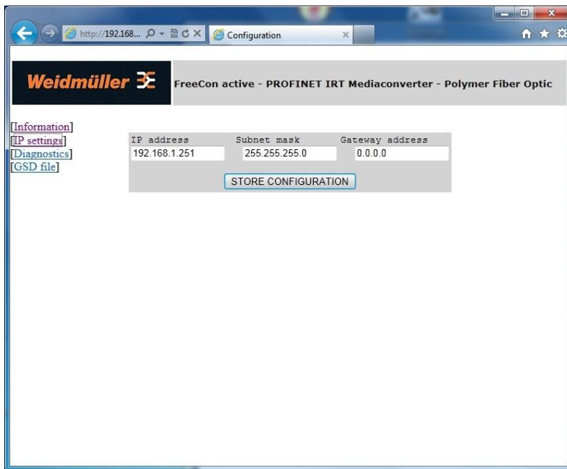
Abb. 13 Konfigurieren des FreeCon Active PROFINET-POF-Medienkonverter mit Hilfe des Webbrowsers
