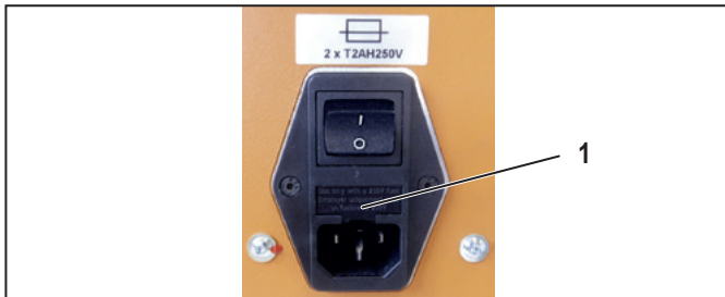
Figura 8.6 Apertura del compartimento fusibili
