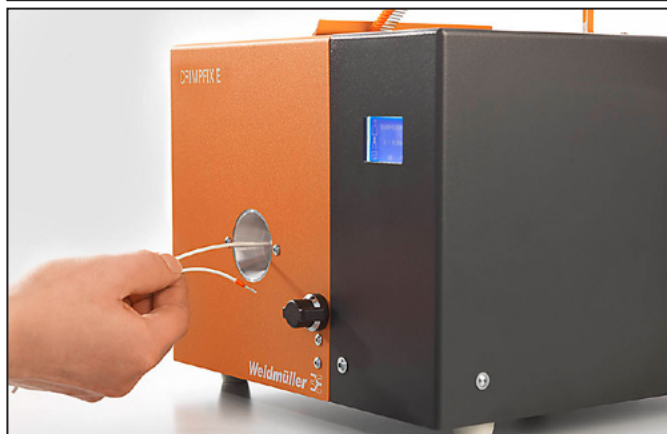
Ilustracja 6.1 Prawidłowo wprowadź przewód
