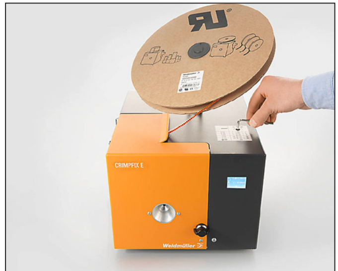
5.2 ábra A csupaszítási fokozat állítása
