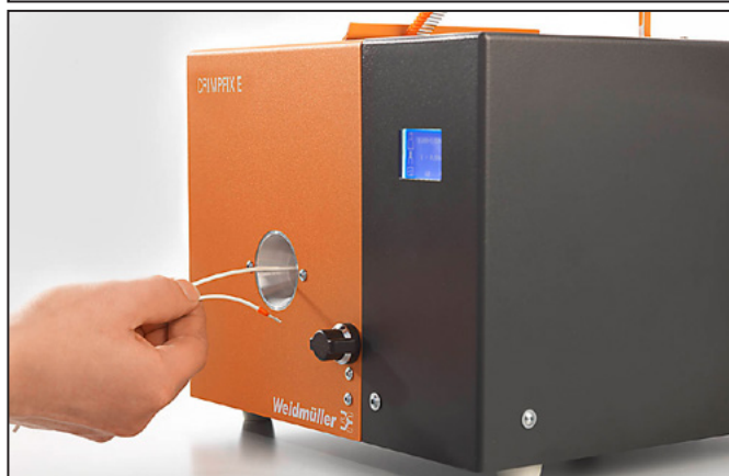
Bild 6.1 För in ledaren korrekt
