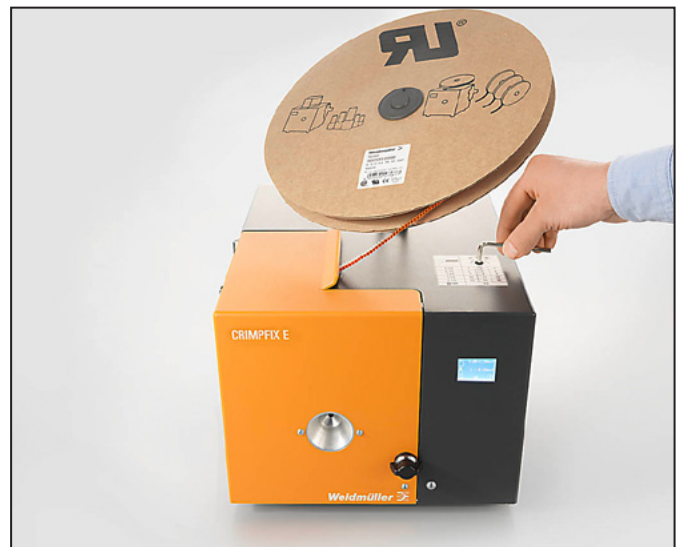
Figura 5.2 Ajuste do grau de descarnamento
