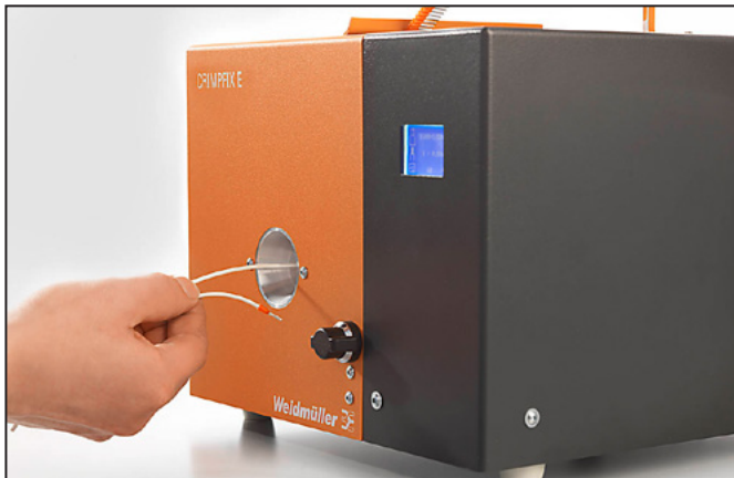
Figura 6.1 Inserire il filo correttamente
