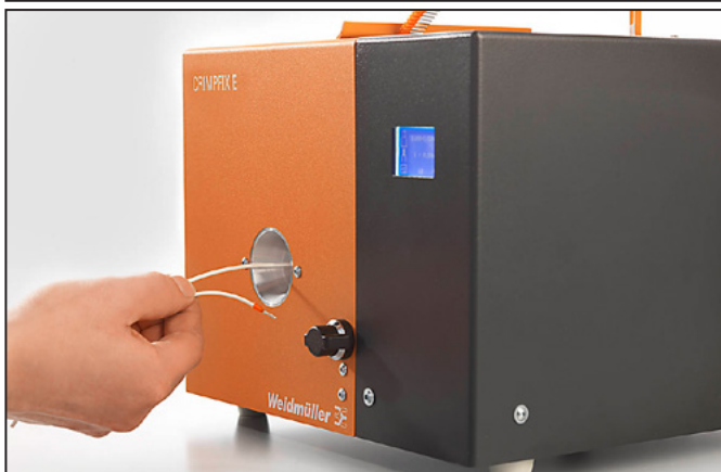
Kuva 6.1 Johtimen oikeaoppinen asettaminen
