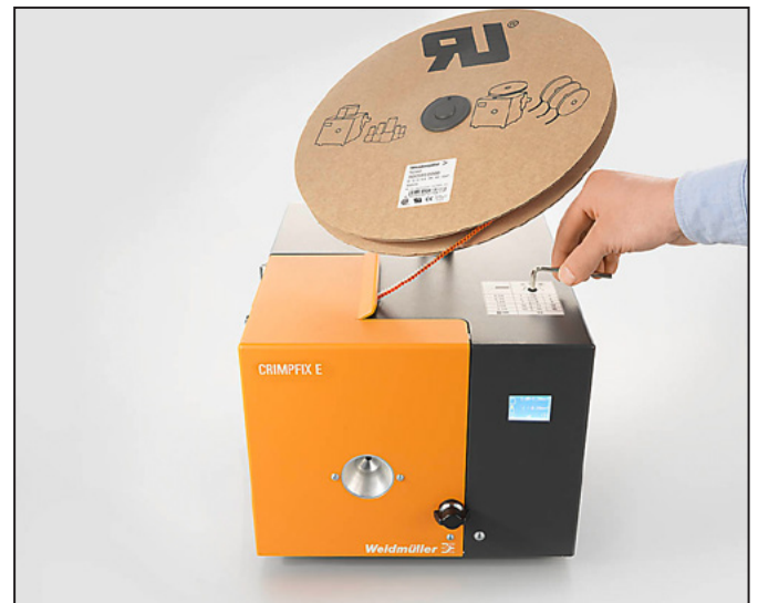
Figure 5.2 Paramétrage du dénudage
