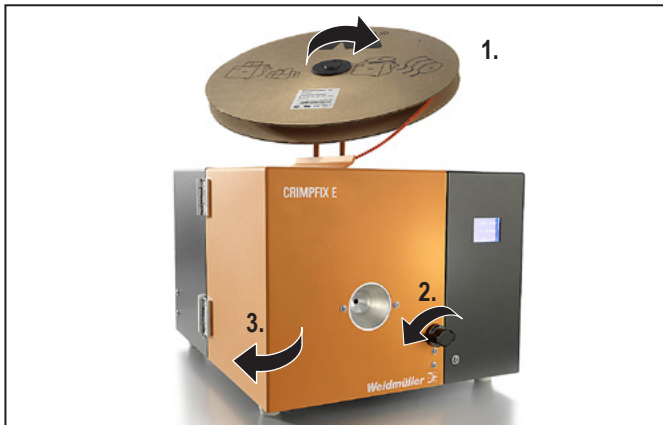
Ilustración 5.6 Colocación del terminal tubular
