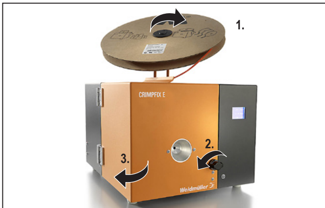
Figure 5.6 Mettre en place le rouleau d'embouts de câble
