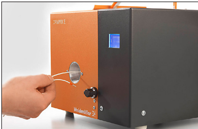
Afbeelding 6.1 Voer de draad correct in
