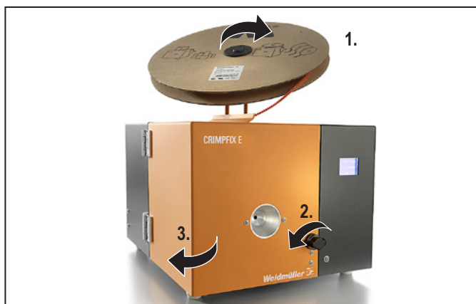
Figura 5.6 Posicionar a ponteira
