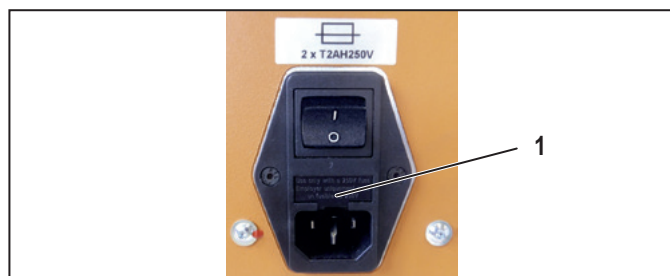
Ilustración 8.6 Apertura del compartimento del fusible
