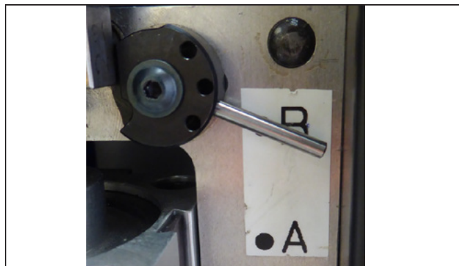
Imagine 5.6 Configurația unității de fixare a cablului torsadat (setare: B)
