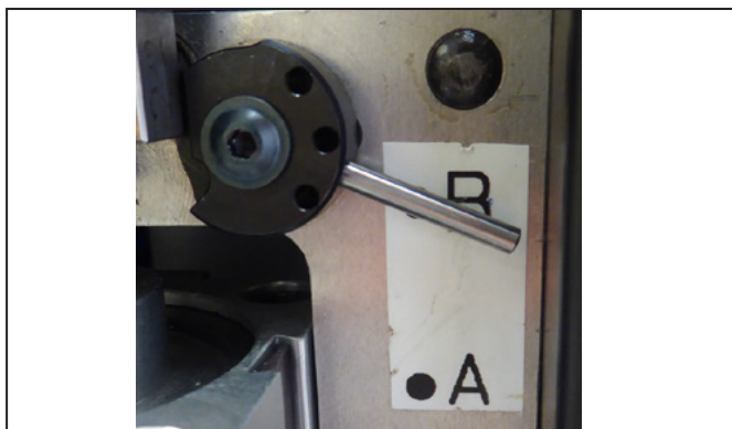
5.6 ábra Sodrott vezeték rögzítőegységének konfigurálása (beállítás: B)
