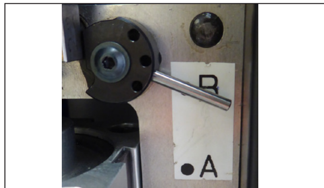
图5.6 多股导线固定装置的配置（设置：B）
