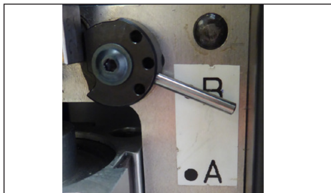
Figure 5.11 Configuration de l'unité de fixation des conducteurs semi-rigides (réglage : B)
