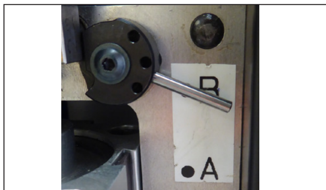
Bild 5.6 Einstellung Litzenfixiereinheit (eingestellt: B)
