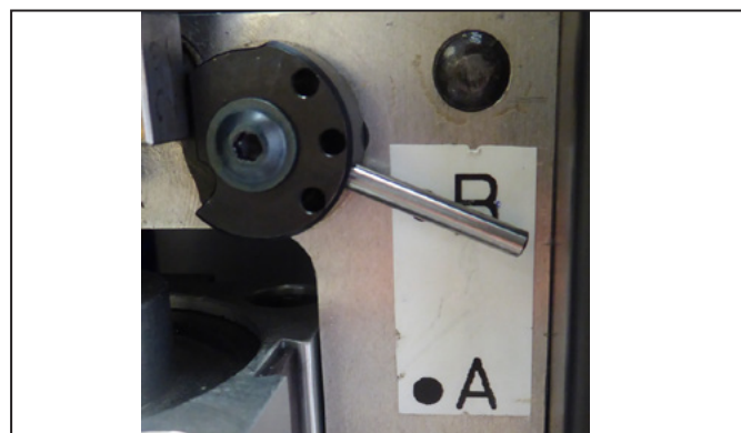
Figura 5.6 Configurazione dell'unità di fissaggio trefoli (impostazione: B)
