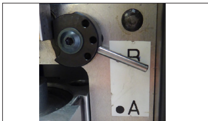
Ilustrace 5.6 Nastavení jednotky na upnutí splétaného vodiče (nastavení: B)
