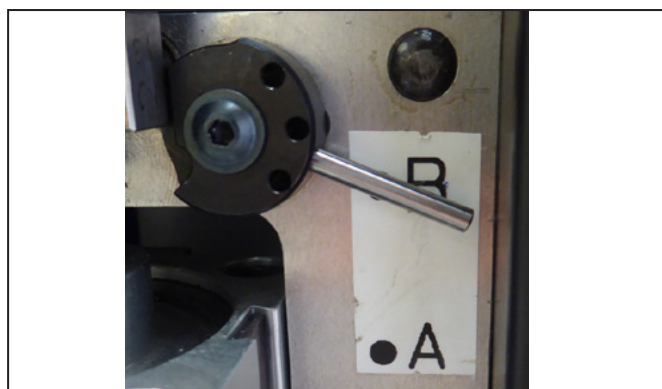
Bild 5.6 Montagehållare för flertrådiga ledare (inställt: B)
