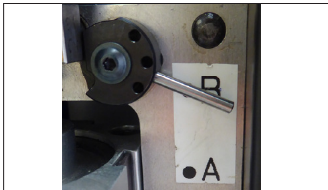
Ilustracja 5.6 Uchwyt mocowania przewodu wielodrutowego - konfiguracja (ustawienie: B)
