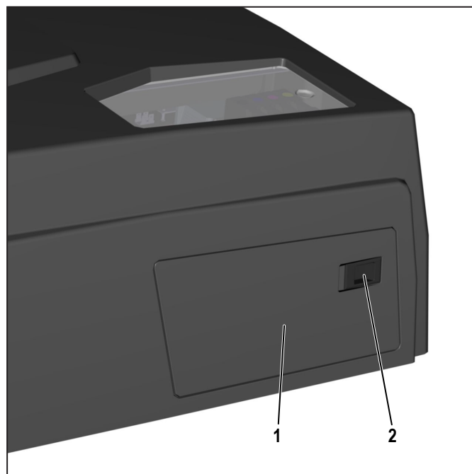
Ilustración 6.20 Abrir la tapa lateral
