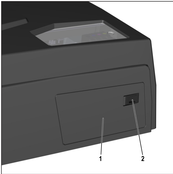
Ilustración 6.7 Abrir la tapa lateral
