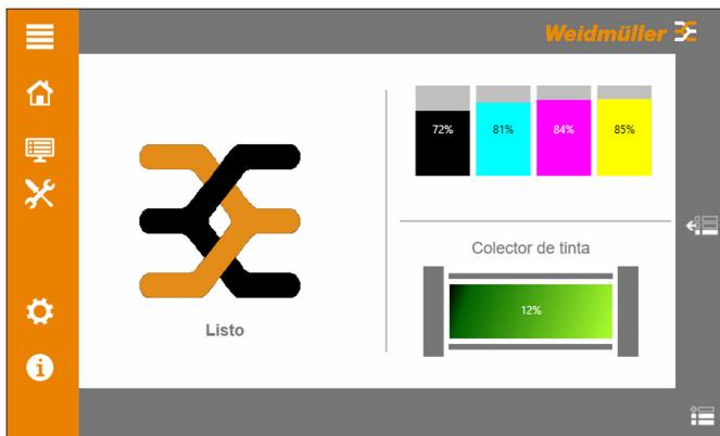
Ilustración 4.17 Panel táctil: menú principal “Estado del sistema”
