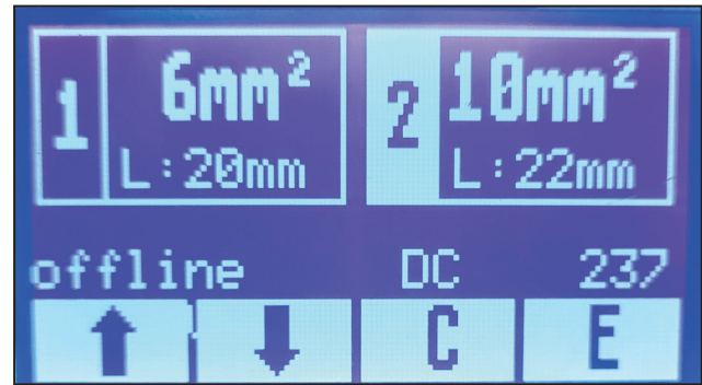
Bild 7.2 Touchdisplay, Anzeige nach dem Einschalten
