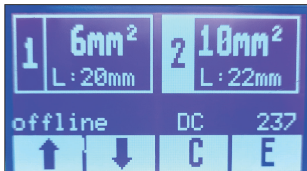
Immagine 7.2 Touch screen, visualizzazione dopo l'accensione
