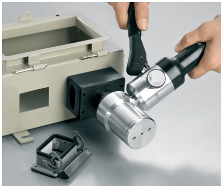
Nehéz csatlakozókhoz készült bélyegek esetén automatikus pontozás a furatok számára tervezett helyeken.
