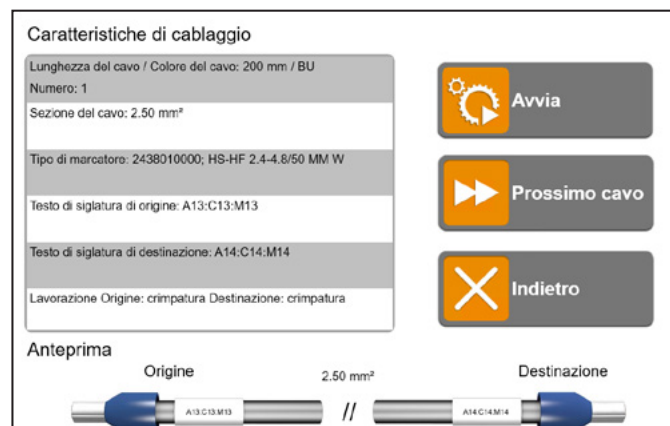
Figura 7.1 Vista di esecuzione dell'ordine di lavorazione
