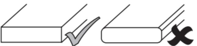
D Es ist sicherzustellen, dass die richtige Sammelschiene eingesetzt wird!
