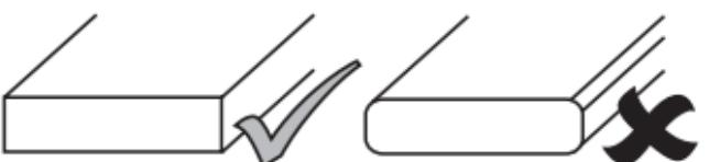
D Es ist sicherzustellen, dass die richtige Sammelschiene eingesetzt wird!
