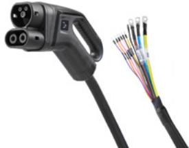
Mode 4 Ladekabel für bis zu 150 kW Ladeleistung, 150 A Ladestrom, interne Temperaturüberwachung, Anschluss Ladepunkt: offenes Leitungsende, Anschluss an Fahrzeug: CCS2-Stecker, 5m Kabellänge, Steckerfarbe schwarz, Kabelfarbe schwarz
