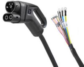
Mode 4 Ladekabel für bis zu 200 kW Ladeleistung, 200 A Ladestrom, interne Temperaturüberwachung, Anschluss Ladepunkt: offenes Leitungsende, Anschluss an Fahrzeug: CCS2-Stecker, 5m Kabellänge, Steckerfarbe schwarz, Kabelfarbe schwarz
