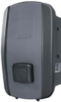
Mode 3 Wallbox AC SMART ADVANCED, max. Ladeleistung von 11 kW bei 3-phasigem (400 V) Netzanschluss, maximaler Ladestrom 16 A, angeschlagenes 5/7,5/10 m Kabel mit Typ 2 Stecker, RFID-Authentifizierung, MID-konformer Energiezähler, integrierter Webserver mit dynamischem Lastmanagement, Mobile App, Schnittstellen: Mobilfunk (4G/LTE), 2x Ethernet, WLAN, Bluetooth low energy, RS 485, 5 DI, 1 DO, Powerline-Kommunikation (AutoCharge)
