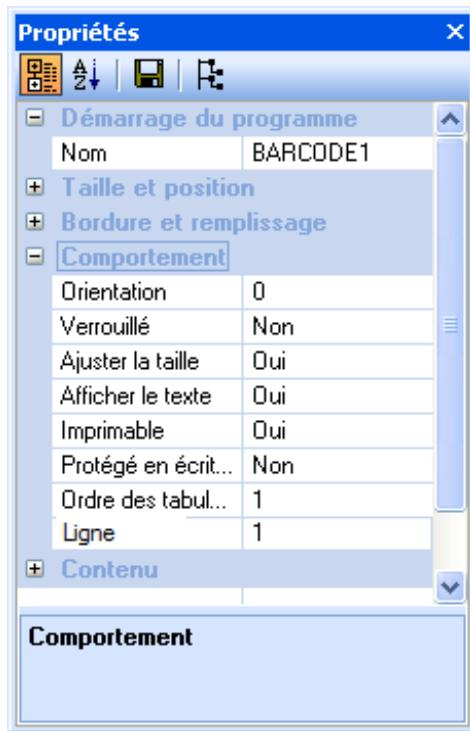
Orientation      - Orientation de l'élément par pas de 90 degrés.
