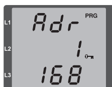
Fig.: TCP/IP address, byte 1:
