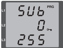
Fig.: Subnet mask (Sub), byte 0, value 255
