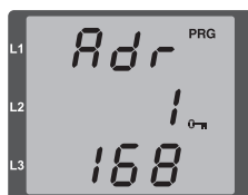
Fig.: TCP/IP address, byte 1
