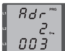
Fig.: TCP/IP address, byte 2, value 003
