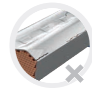
圧着した谷の部分に亀裂が入る
