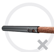
絶縁被覆の損傷
