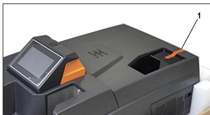
Рис. 4.1 Транспортировочные фиксаторы
