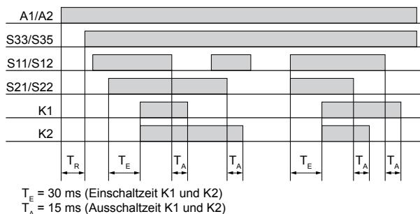
$T_E = \text{typ. } 50 \text{ ms}$  (Reaktionszeit mit Brücke C1/C2)
